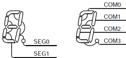
图11.6 1/4占空 (1/3偏压) 型LCD的COM与SEG引脚连接范例
